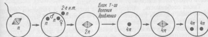
Рис. 38. Схема получения тетраплоидных рыб путем блокирования первого деления дробления у зародышей (н. т. — направительное тельце)
